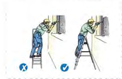
รูปที่ 4: ไม่ถูกต้อง - หันด้านข้างตัวเข้าทำงาน (ซ้าย) ถูกต้อง - หันตัวเข้าทำงาน (ขวา)
