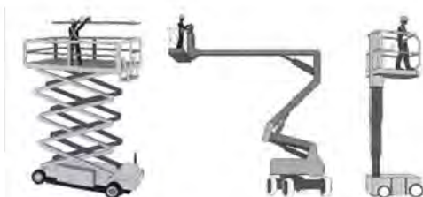
รูปที่ 5.1: ตัวอย่างของ MEWPs; รถกระเช้า (ซ้าย) ลิฟท์บูม (กลาง) และแพลตฟอร์มแนวตั้ง (ขวา)
