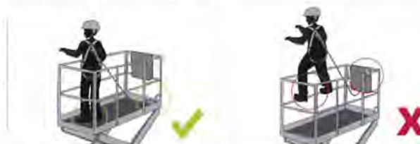
รูปที่ 6: วิธีการที่ถูกต้องของการทำงานในรถกระเช้า (MEWP) (ซ้าย) และปฏิบัติที่ไม่ปลอดภัย (ขวา)
