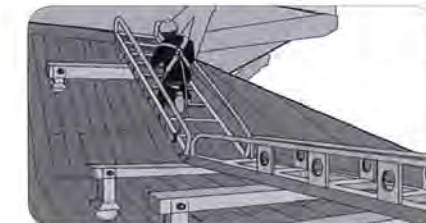
รูปที่ 8.2: กระดานขึ้นตะขาบ, สะพานทางเดิน และราวกันตก สามารถเพิ่มความปลอดภัย สำหรับการทำงานบนหลังคาลาดเอียง
