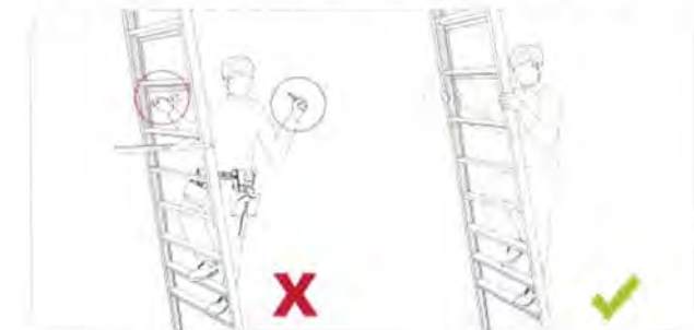
รูปที่ 2: ไม่ถือเครื่องมือ และ วัสดุด้วยมือ และควรเก็บอยู่ในกระเป๋าสานหรือ กระเป๋าข้าง (ซ้าย) ใช้หลัก three points of contact (ขวา)
